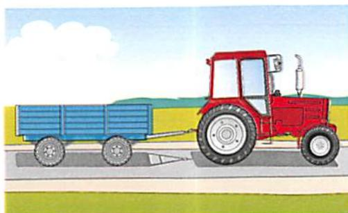
1. Торможение машины должно опережать торможение прицепа.
