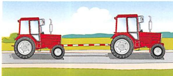
1. Неисправна рабочая тормозная система.
