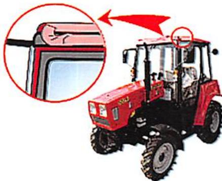
1. Допускается наличие трещин длиной не более 5 мм.
