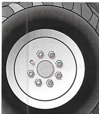
1. Разрешается без одной гайки.
