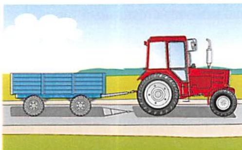
1. Торможение машины должно опережать торможение прицепа.
