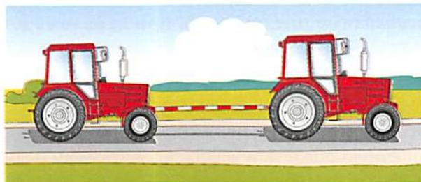
1. Неисправна рабочая тормозная система.
